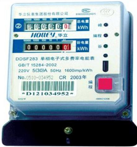
DDSF283 单相电子式多费率电能表采用精简指令的微处理器, 双字轮计数器指示, 具有可靠性高, 方便抄表, 过载能力强, 结构坚固等优点, 实现二费率分时计量, 适于大面积推广分时电量计价居民单相用电的领域, 实现民用分时计费, 与工业分时计费政策互补, 更好地均衡了电网负荷。
