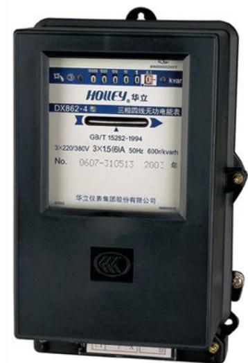
D86 系列三相感应式电能表, 适用于频率为 50Hz 三相交流电网的工业和民用及电能计量。按接线方式可分为四线和三线两大类, 按测量电能可分为有功和无功两大类, 最大过载能力为四倍。
