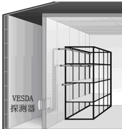
图6 – 货架间采样示例
