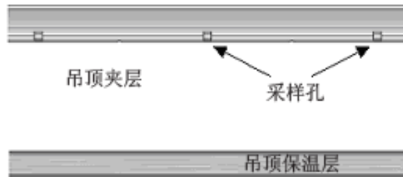
图7 – 吊顶夹层采样示例
